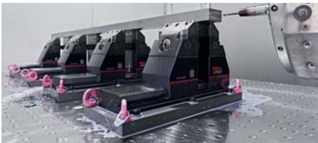
Spühl spannt je Palette ein bis zwei Teile mit bis zu acht 5-Achs-Spannern Garant Xpent.
