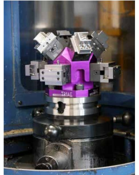
Die Triag International AG fertigt modulare und flexible Spannsysteme in der Schweiz. Diese Systeme erlauben eine unbeaufsichtigte Fertigung bei minimalem Spannplatz. So werden Aufwand und Kosten für Spannelemente minimiert und die Produktivität erhöht.
